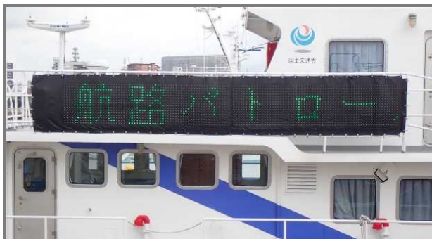
写真-6 電光表示装置
