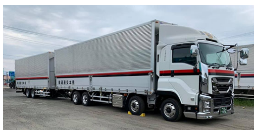
全長21mのダブル連結トラック
